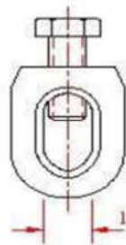
Kẹp sắt-Steel grounding clamp Khối lượng-Weight (kg): 0.065
